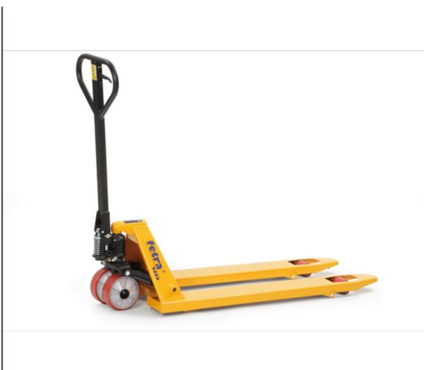
Rahmen und Gabeln in verwindungsfreier Schalenbauweise, gelb pulverbeschichtet. Hydraulische Handpumpe wartungsfrei gelagert. Stabile Stahlrohrdeichsel mit Gegenlager für Schubbetrieb, pulverbeschichtet schwarz, Deichselgriff pulverbeschichtet. Gabelrollen Ø x B = 80 x 93 mm. Bedienhebel für die Funktionen: Heben - Fahren - Senken. Lenkeinschlag 2 x 100°. Lenkräder Ø x B = 200 x 50 mm. Berädung: Geringer Rollwiderstand, nicht kreidend.
