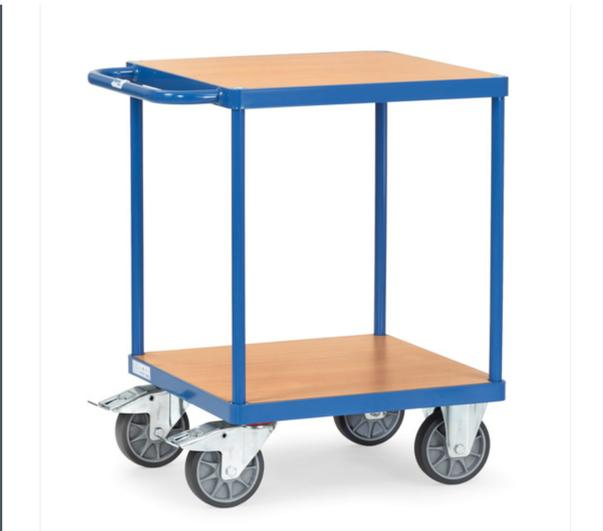
Stahlrohr und Profilstahl geschweißt, pulverbeschichtet RAL 5007. 2 Plattformen aus Holzwerkstoffplatte, Oberfläche Buchendekor. 2 Lenk- und 2 Bockrollen, TPE-Bereifung, Naben mit Rillenkugellager. Feststeller an den Lenkrollen, gemäß der Europäischen Norm EN 1757-3 (Sicherheit von Plattformwagen). Tragkraft obere Ladefläche 200 kg.
