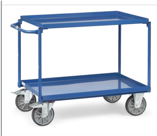
Stahlkonstruktion, geschweißt. Mit 2 Stahlblechwannen. Stahlrohrbügel und Stahlblechwannen verschraubt. Wannen öldicht, Rand 40 mm hoch. Pulverbeschichtet RAL 5007. Schiebegriff waagrecht. 2 Lenk- und 2 Bockrollen, TPE-Bereifung, Naben mit Rillenkugellager. Feststeller an den Lenkrollen, gemäß EN 1757-3 (Sicherheit von Plattformwagen). Tragkraft obere Ladefläche 200 kg.
