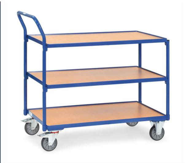
Stahlrohr und Profilstahl geschweißt, pulverbeschichtet. Schraubkonstruktion. 3 Böden aus Holzwerkstoffplatte, Oberfläche Buchendekor, im Stahlrahmen liegend, Rand 12 mm hoch. Schiebegriff hochstehend. 2 Lenk- und 2 Bockrollen, TPE-Bereifung, Naben mit Rillenkugellager. Feststeller an den Lenkrollen, gemäß der Europäischen Norm EN 1757-3 (Sicherheit von Plattformwagen). Tragkraft obere und mittlere Ladefläche 80 kg.
