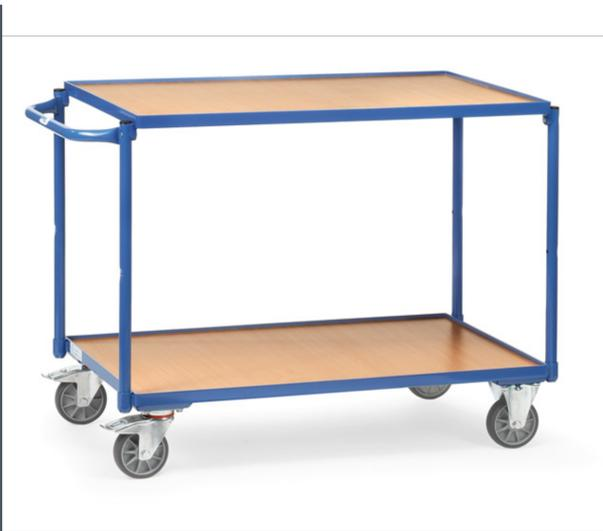
Stahlrohr und Profilstahl geschweißt, pulverbeschichtet. Schraubkonstruktion. 2 Böden aus Holzwerkstoffplatte, Oberfläche Buchendekor, im Stahlrahmen liegend, Rand 12 mm hoch. Schiebegriff waagrecht. 2 Lenk- und 2 Bockrollen, TPE-Bereifung, Naben mit Rillenkugellager. Feststeller an den Lenkrollen, gemäß der Europäischen Norm EN 1757-3 (Sicherheit von Plattformwagen). Tragkraft obere Ladefläche 80 kg.
