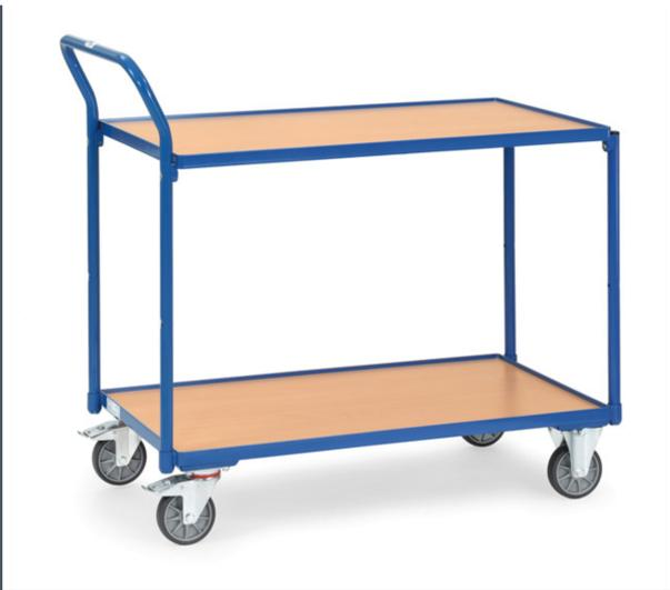
Stahlrohr und Profilstahl geschweißt, pulverbeschichtet. Schraubkonstruktion. 2 Böden aus Holzwerkstoffplatte, Oberfläche Buchendekor, im Stahlrahmen liegend, Rand 12 mm hoch. Schiebegriff hochstehend. 2 Lenk- und 2 Bockrollen, TPE-Bereifung, Naben mit Rillenkugellager. Feststeller an den Lenkrollen, gemäß der Europäischen Norm EN 1757-3 (Sicherheit von Plattformwagen). Tragkraft obere Ladefläche 80 kg.
