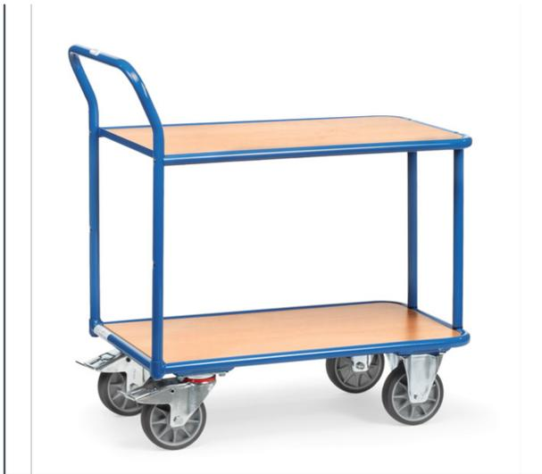
Profilstahl-/Stahlrohr-Schweißkonstruktion, pulverbeschichtet, blau RAL 5007. 2 Böden aus Holzwerkstoffplatte, Oberfläche Buchendekor. 2 Lenk- und 2 Bockrollen, TPE-Bereifung, Naben mit Rillenkugellager. Feststeller an den Lenkrollen, gemäß der Europäischen Norm EN 1757-3 (Sicherheit von Plattformwagen).
